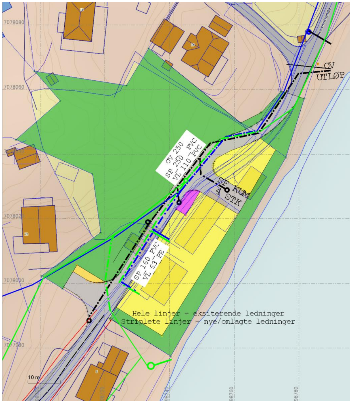
Situasjonskart med forslag til trase og ledningstype/størrelse
